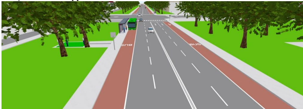
Şəkil 3. Avtobus zolağı tətbiq edildikdən sonra küçədə hərəkətin təşkilinin simulyasiya modelinin 3D görüntüləri
