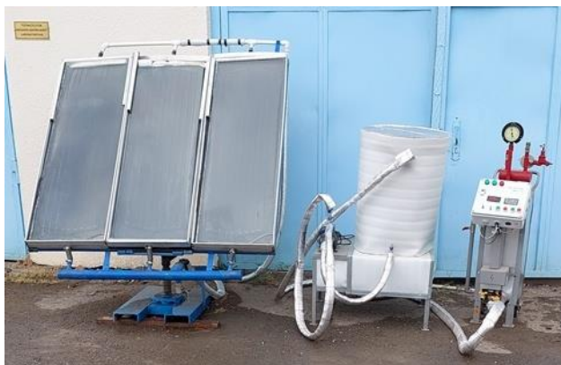
Şəkil 1. Günəş kollektoru və su istilik akkumulyatorun ümumi görünüşü.
