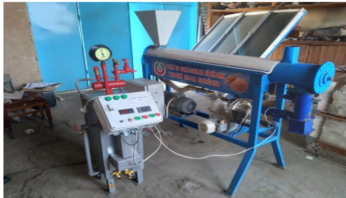
Şəkl 2. Dənli və dənli-paxlalı bitkilərin buxarla termiki emalını həyata keçirən eksperimental qurğunun ümumi görünüşü
